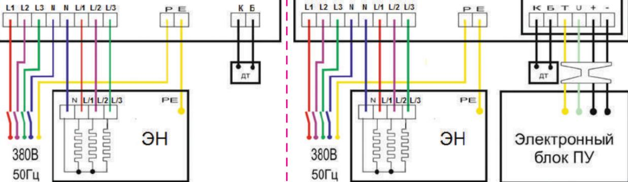
**Схема 1а.** Подключение ЭН с ПУ-03-М3
